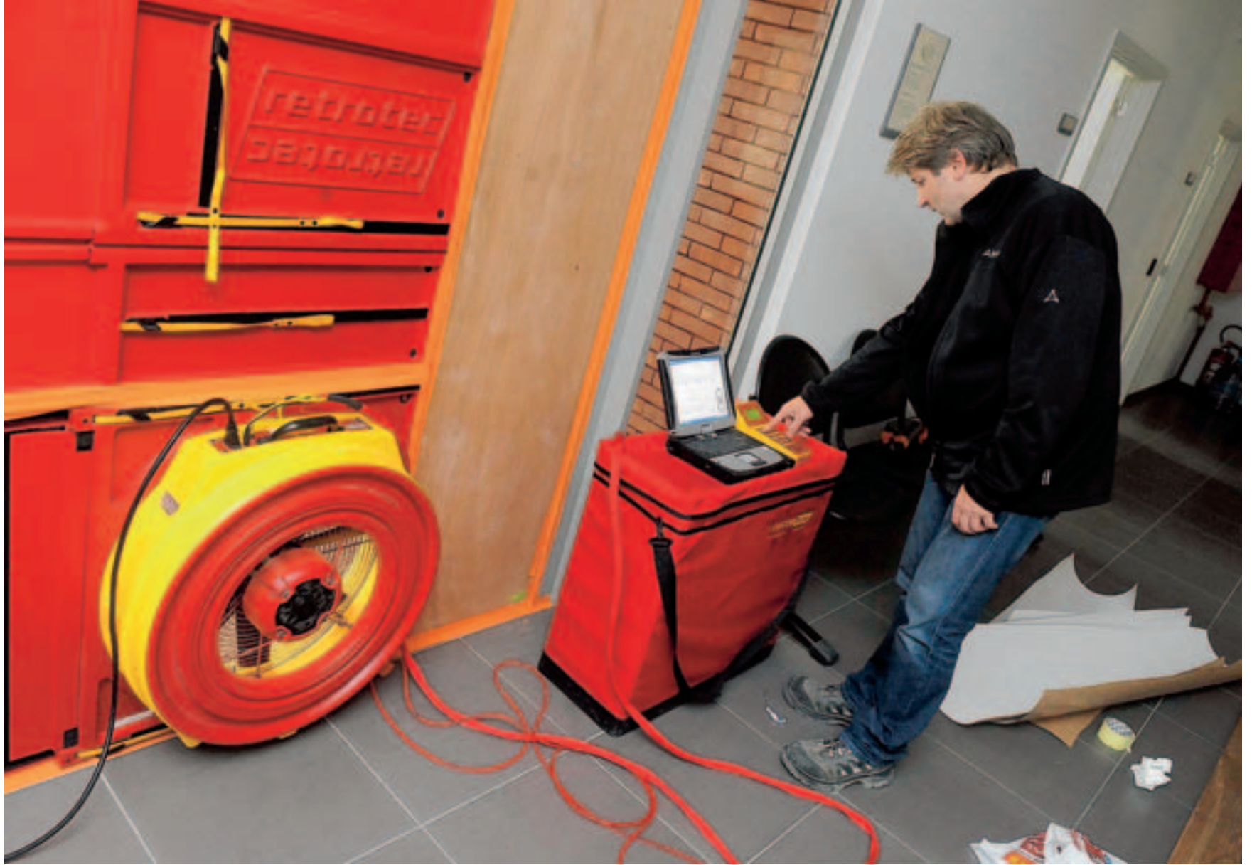
Marc Etienne vient d'activer le ventilateur installé sur la porte étanche qui donne accès au rez-de-chaussée. Sur son ordinateur, il contrôle les différents paramètres utiles pour détecter les fuites. Parmi son matériel, une caméra thermique. Impitoyable, aucun problème d'étanchéité ne lui résiste. © ALAIN DEWEZ
