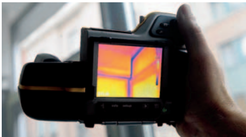
Marc Etienne vient d'activer le ventilateur installé sur la porte étanche qui donne accès au rez-de-chaussée. Sur son ordinateur, il contrôle les différents paramètres utiles pour détecter les fuites. Parmi son matériel, une caméra thermique. Impitoyable, aucun problème d'étanchéité ne lui résiste. © ALAIN DEWEZ
